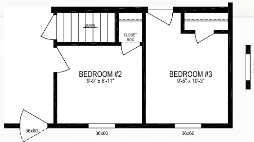
OPTIONAL BASEMENT STAIRWELL
